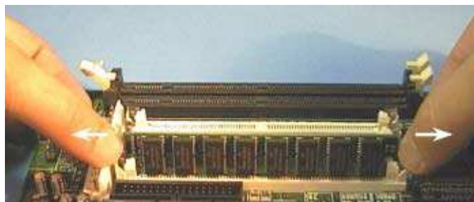
Figura 2.7 Retirando um módulo de memória SIMM
