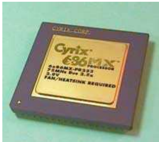
Figura 3.6 Este Cyrix 6x86MX opera com clock externo de 75 MHz
