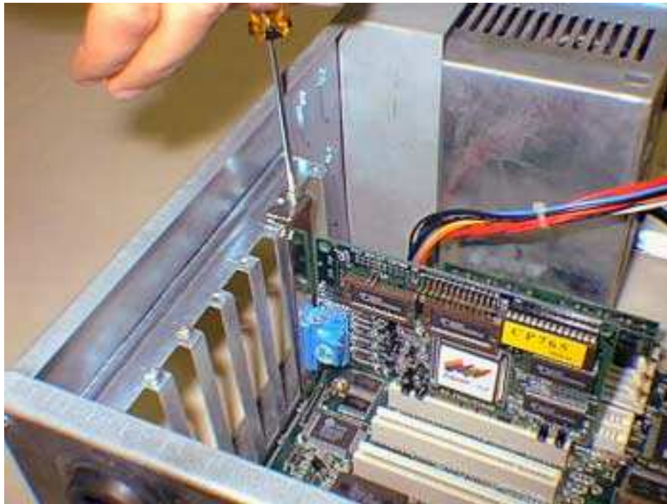
Figura 2.20 Aparafusando uma placa de expansão no gabinete.
