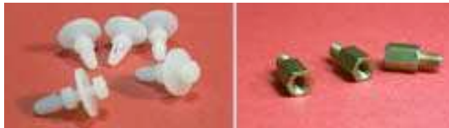
Figura 2.16 Espaçadores plásticos e parafusos de fixação da placa de CPU
