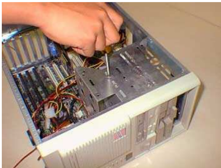
Figura 2.21 Aparafusando os drivers no gabinete.
