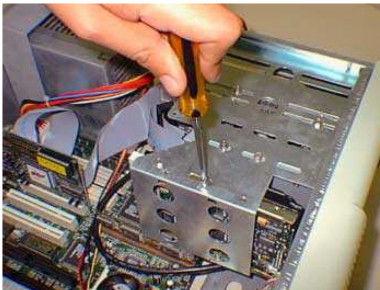
Figura 2.22 Aparafusando o disco rígido no gabinete
