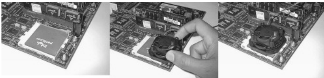
Figura 1.2 Acoplado um microventilador no processador
