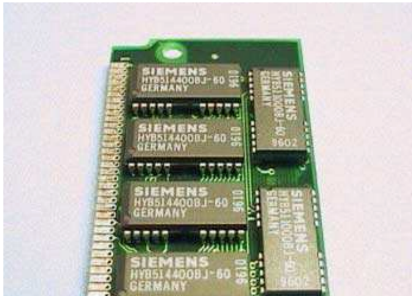
Figura 1.13 Módulo de memória com tempo de acesso de 60 ns.
