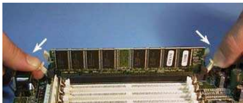
Figura 2.9 Removendo um módulo DIMM/168.
