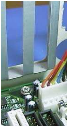
Figura 4.11 - Conectando a fonte de alimentação AT na placa de CPU.
